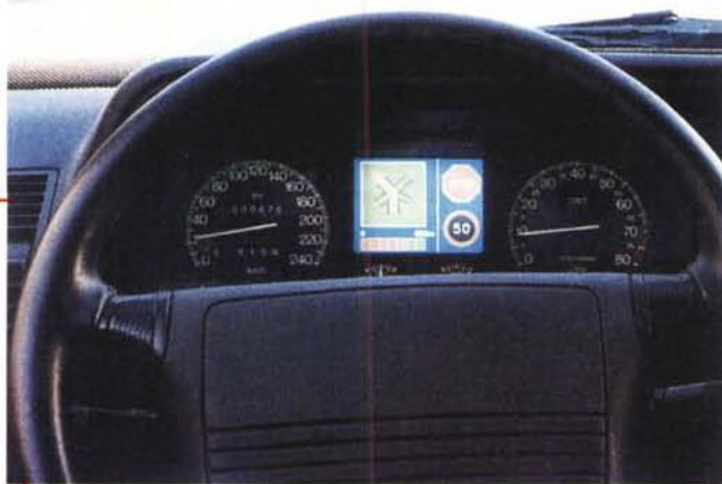
Fig. 10: Anche FIAT utilizza interfacce grafiche a colori per comunicare con il guidatore nelle procedure di Cooperative Driving e di pianificazione automatica di percorsi alternativi. Il sistema è stato denominato FIAT Ite-link.
